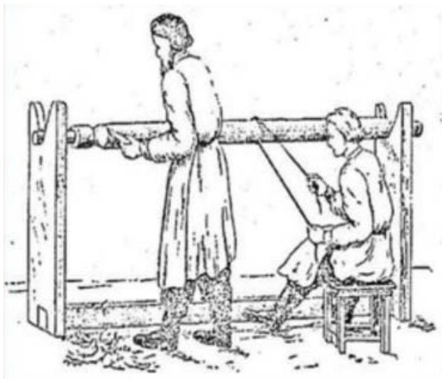
Станок представлял собой два соосно установленных центра, между которыми зажималась заготовка из дерева, кости или рога. Раб или подмастерье вращал заготовку (один или несколько оборотов в одну сторону, затем в другую). Мастер держал резец в руках и, прижимая его в нужном месте к заготовке, снимал стружку, придавая заготовке требуемую форму.
